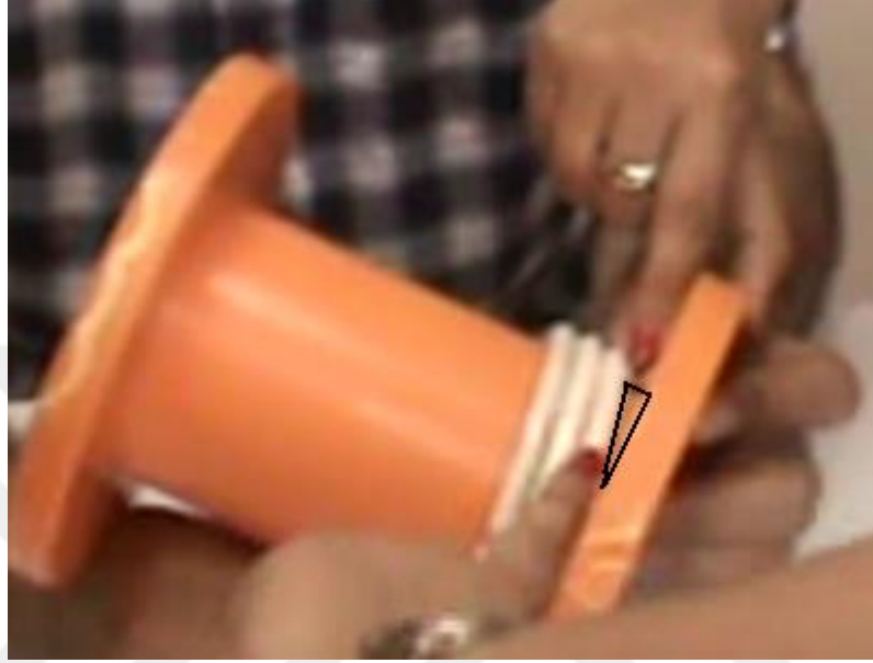
Şekil 10: Kablo Sarılırken İlk Sıranın Başında Oluşan Boşluk
