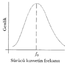
Şekil 50: Farklı Zorlanmış Frekanslarda Salınan Bir Rezonant Sisteme Ait Grafik (Serway ve Beichner, 2007a)
