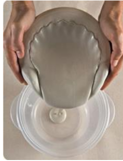
Şekil 37: Kalıp ile Seramik Biçim Oluşturma Aşamaları Kaynak: https://pin.it/e47cgxhaqdpqgj
