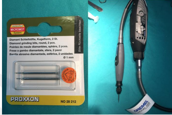
Şekil 3.15: Çalışmada kullanılan tur motoru ve elmas ucu
