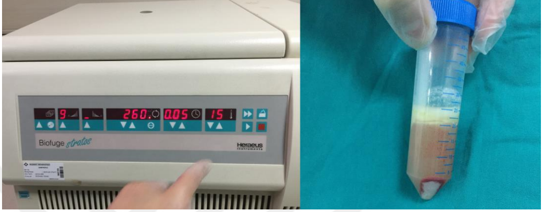
Şekil 3.7: Santrifüj cihazının ayarlanması ve süspansiyonun santrifüj sonrası görüntüsü
