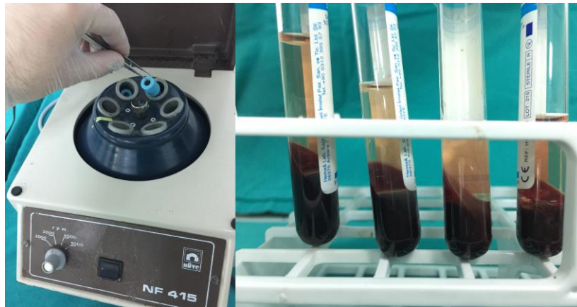
Şekil 3.12: Sodyum sitratlı tüplerin santrifüj cihazından dikkatli alınması ve TZP'nin santrifüj sonrası görüntüsü.
