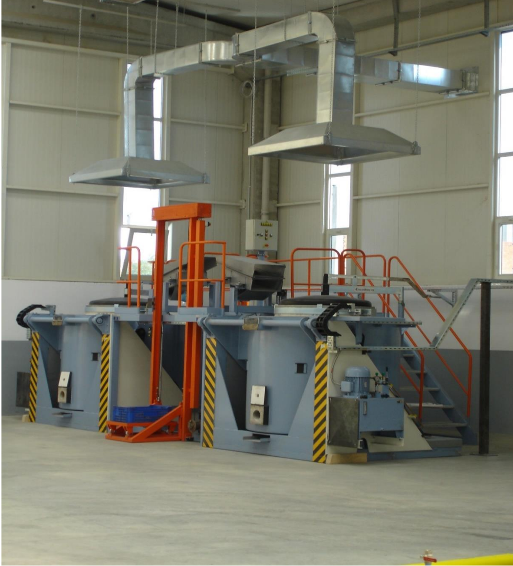
Şekil 2 3 Potalı Ergitme Fırınları
