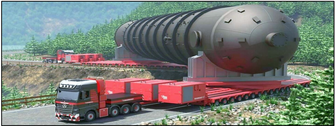
Şekil :3.15. Hidrolik Treyler Üzerinde Döner Tabla Donanımı Kullanımı (WEP_4, 2017)
