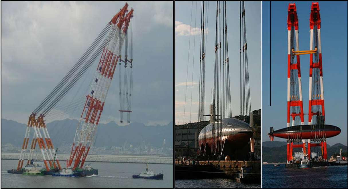
Şekil:3.49. Yüzer Vinç Genel Görünüm Ve Kullanım Örneği (WEP_9, 2017)
