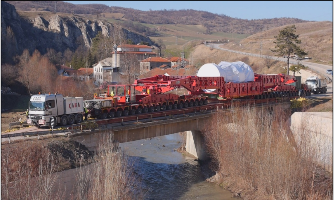
Şekil:3.55. Portatif Çelik Köprü Kullanımı (Çaba, 2016)
