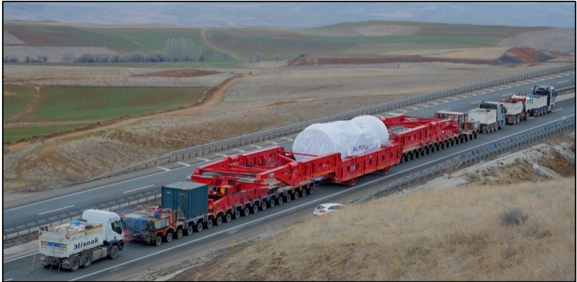
Şekil :3.1.6. Hidrolik Treyler Üzerinde Askı Ekipmanı Kullanımı (Çaba-KIPP, 2015)
