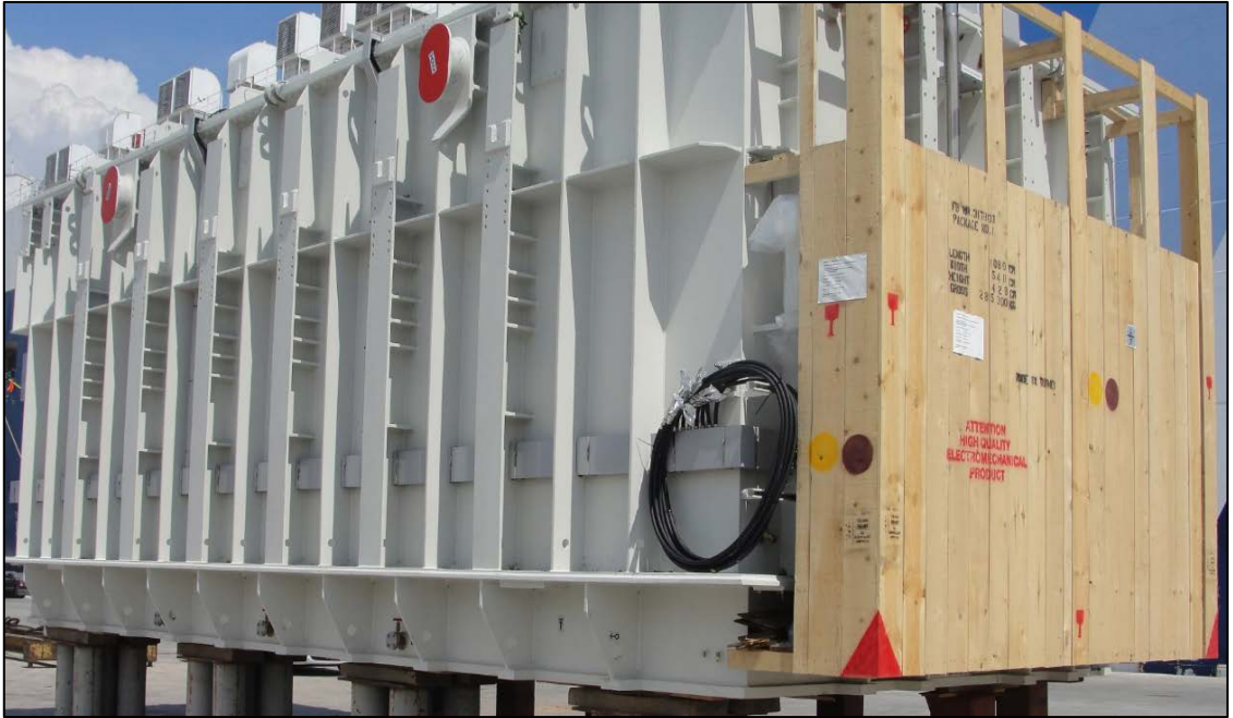
Şekil:2.2. Ağır Yük Örneği, 285 Ton Ağırlığında Elektrik Trafosu (Çaba 2009 )
