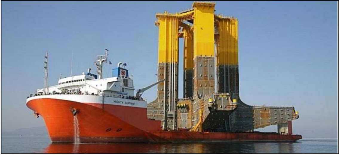
Şekil :3.29. Yarı Batar Denizyolu Taşıma Örneği (Marine Insight, 2016)
