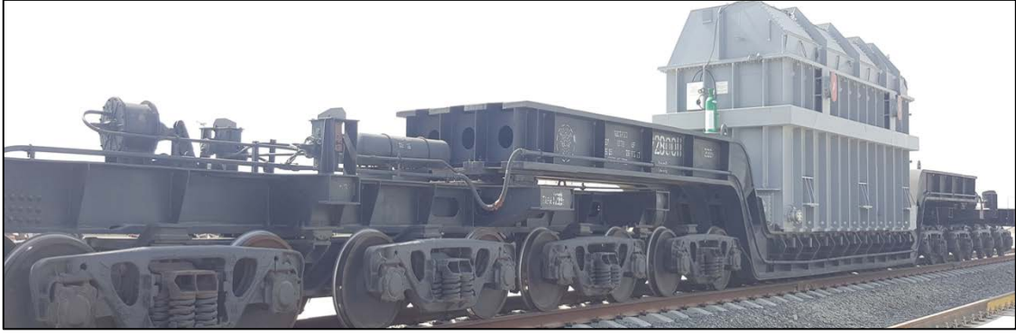
Şekil :3.33. 3927 Tip Demiryolu Aracı İle Taşıma Örneği (Çaba, 2017)
