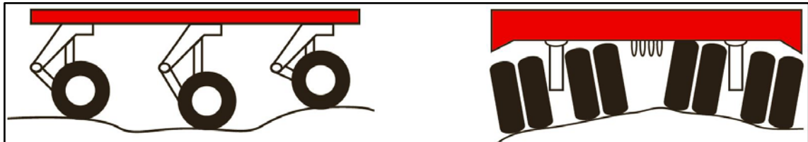
Şekil :3.12. Hidrolik Treylar Aks Grupları Bozuk Yol Şartlarında Hareket Tarzları (Scheuerle, 2017)
