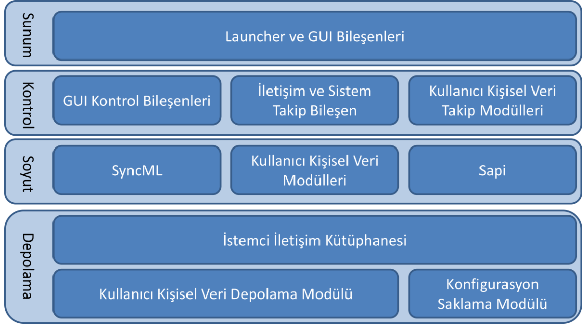
Şekil 3.2.1.5 PIPSU-L katmanlı yapısı ve alt bileşenleri
