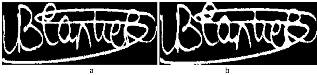
Şekil 26: (a) Özgün Görüntü ve (b) 5 Uzunluğunda Soldan Sağa Yapıcı Ögesi ile Kapanım Uygulanmış Görüntü
