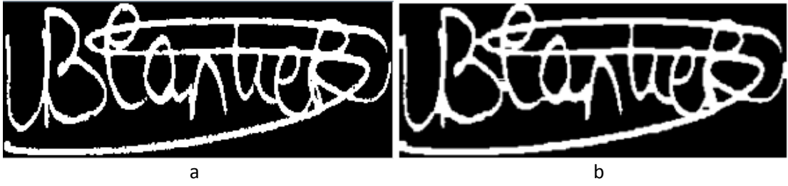
Şekil 39: (a) Özgün Görüntü ve (b) 5 Uzunluğunda Yatay Yapıcı Ögesi ile Kapanım Uygulanmış Görüntü
