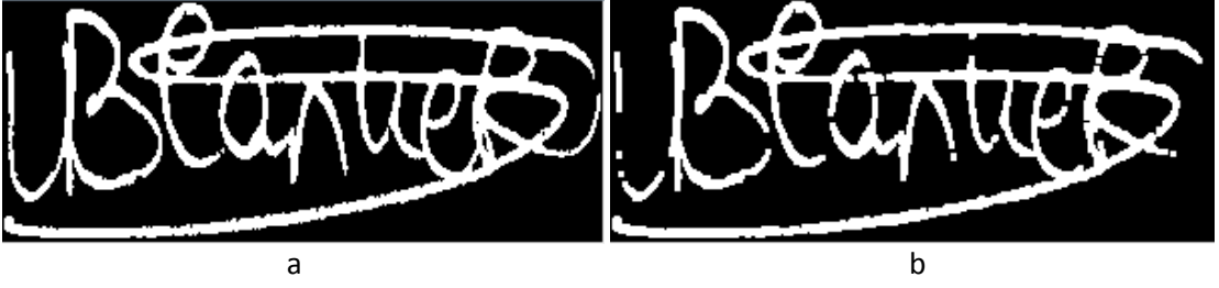
Şekil 17: (a) Özgün Görüntü ve (b) 3 Uzunluğunda Kare Yapıcı Ögesi ile Açılım Uygulanmış Görüntü
