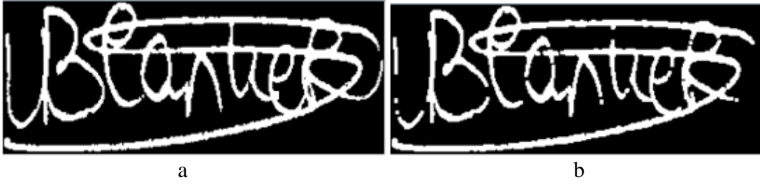
Şekil 22: (a) Özgün Görüntü ve (b) 3 Uzunluğunda Kare Yapıcı Ögesi ile Kapanım Uygulanmış Görüntü
