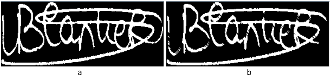
Şekil 13: (a) Özgün Görüntü ve (b) 3 Uzunluğunda Soldan Sağa Çapraz Yapıcı Ögesi ile Açılım Uygulanmış Görüntü
