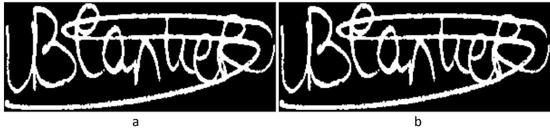
Şekil 27: (a) Özgün Görüntü ve (b) 5 Uzunluğunda Sağdan Sola Yapıcı Ögesi ile Kapanım Uygulanmış Görüntü
