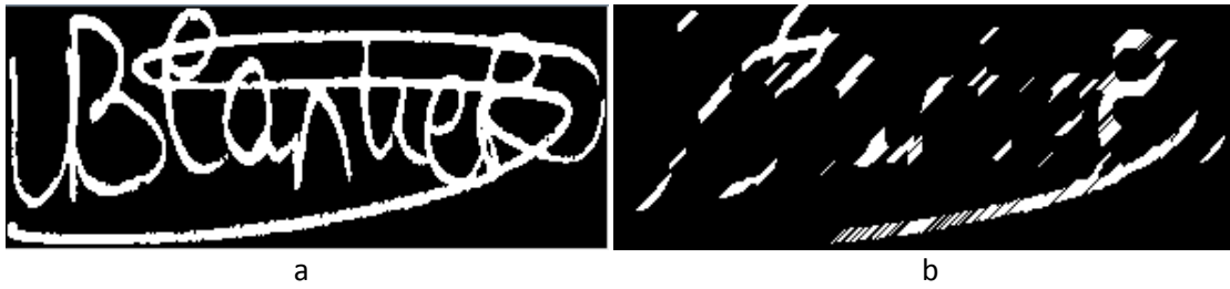
Şekil 21: (a) Özgün Görüntü ve (b) 7 Uzunluğunda Sağdan Sola Yapıcı Ögesi ile Açılım Uygulanmış Görüntü
