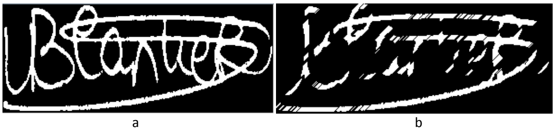
Şekil 19: (a) Özgün Görüntü ve (b) 5 Uzunluğunda Sağdan Sola Çapraz Yapıcı Ögesi ile Açılım Uygulanmış Görüntü
