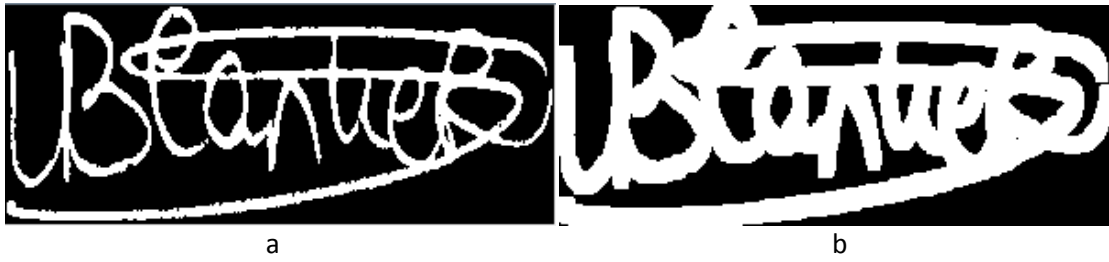
Şekil 13: (a) Özgün Görüntü ve (b) 7 Uzunluğunda Kare Yapıcı Ögesi ile Genleşme Uygulanmış Görüntü
