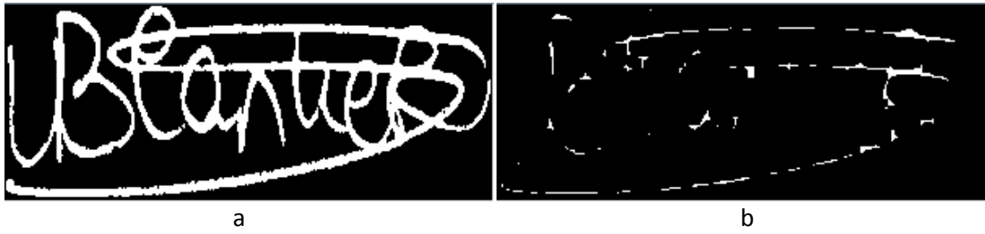
Şekil 11: (a) Özgün Görüntü ve (b) 5 Uzunluğunda Kare Yapıcı Ögesi ile Aşınım Uygulanmış Görüntü
