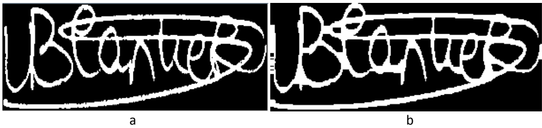
Şekil 30: (a) Özgün Görüntü ve (b) 7 Uzunluğunda Yatay Yapıcı Ögesi ile Kapanım Uygulanmış Görüntü
