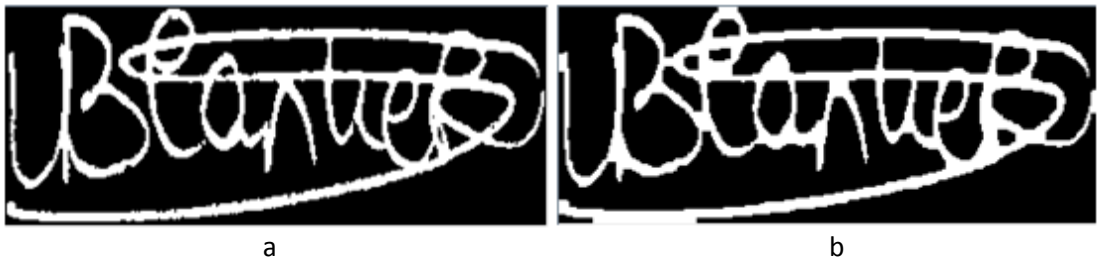
Şekil 37: (a) Özgün Görüntü ve (b) 5 Uzunluğunda Kare Yapıcı Ögesi ile Kapanım Uygulanmış Görüntü
