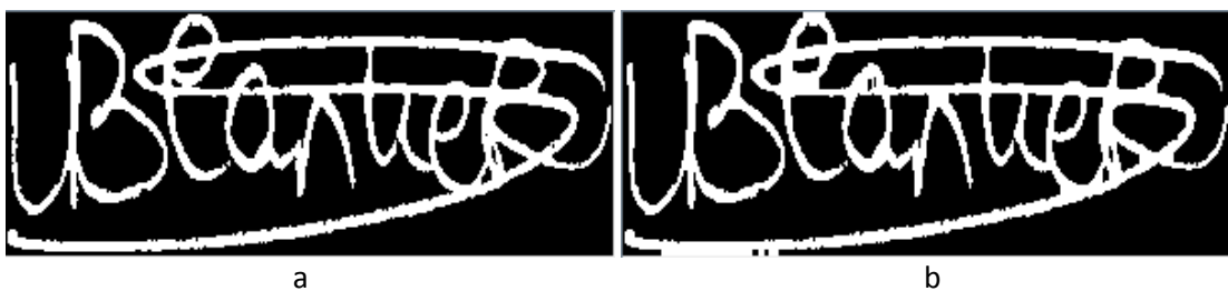
Şekil 38: (a) Özgün Görüntü ve (b) 5 Uzunluğunda Dikey Yapıcı Ögesi ile Kapanım Uygulanmış Görüntü
