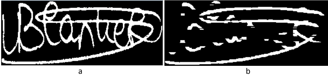
Şekil 29: (a) Özgün Görüntü ve (b) 7 Uzunluğunda Yatay Yapıcı Ögesi ile Açılım Uygulanmış Görüntü
