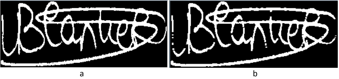
Şekil 19: (a) Özgün Görüntü ve (b) 3 Uzunluğunda Yatay Yapıcı Ögesi ile Açılım Uygulanmış Görüntü
