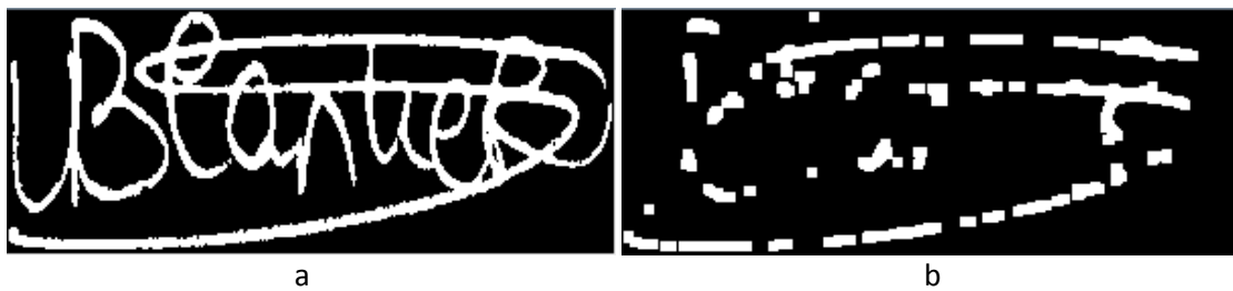
Şekil 15: (a) Özgün Görüntü ve (b) 5 Uzunluğunda Kare Yapıcı Ögesi ile Açılım Uygulanmış Görüntü
