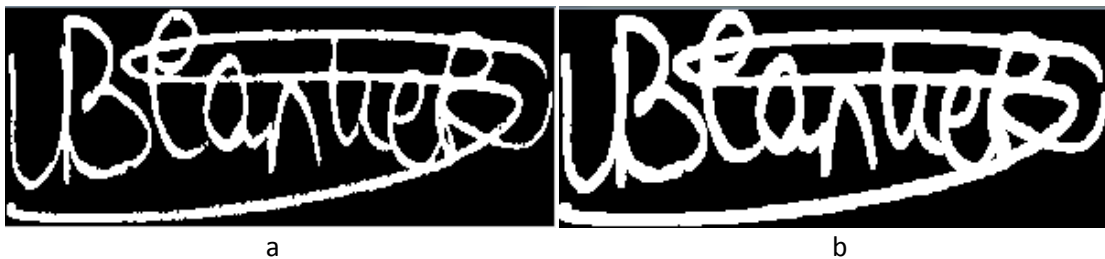
Şekil 11: (a) Özgün Görüntü ve (b) 3 Uzunluğunda Kare Yapıcı Ögesi ile Genleşme Uygulanmış Görüntü
