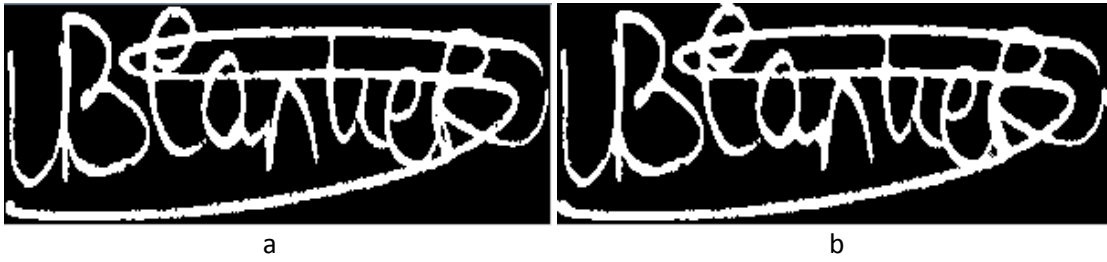
Şekil 25: (a) Özgün Görüntü ve (b) 3 Uzunluğunda Soldan Sağa Yapıcı Ögesi ile Kapanım Uygulanmış Görüntü
