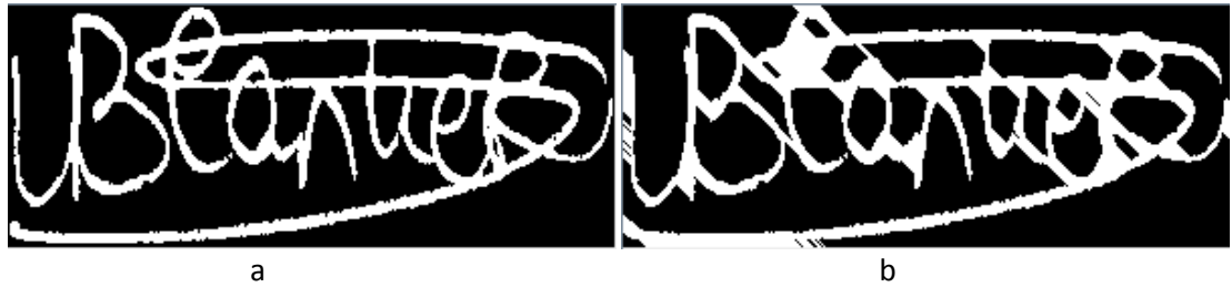
Şekil 31: (a) Özgün Görüntü (b) 7 Uzunluğunda Soldan Sağa Çapraz Yapıcı Ögesi ile Kapanım Uygulanmış Görüntü
