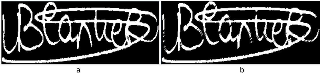
Şekil 14: (a) Özgün Görüntü ve (b) 3 Uzunluğunda Sağdan Sola Çapraz Yapıcı Ögesi ile Açılım Uygulanmış Görüntü
