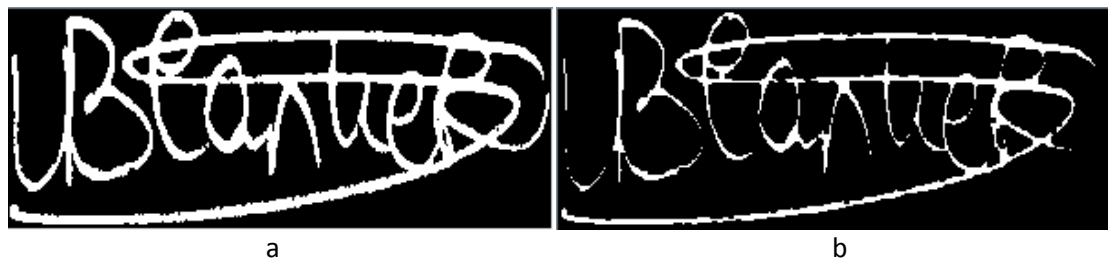
Şekil 14: (a) Özgün Görüntü ve (b) 3 Uzunluğunda Kare Yapıcı Ögesi ile Aşınım Uygulanmış Görüntü
