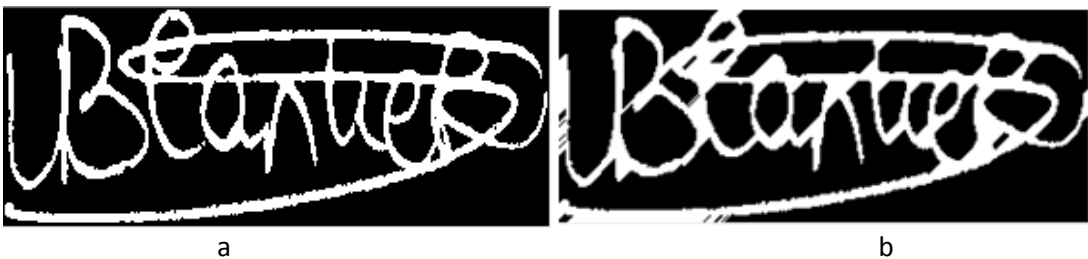
Şekil 46: (a) Özgün Görüntü ve (b) 7 Uzunluğunda Sağdan Sola Çapraz Yapıcı Ögesi ile Kapanım Uygulanmış Görüntü
