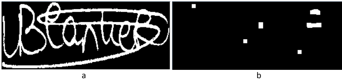
Şekil 27: (a) Özgün Görüntü ve (b) 7 Uzunluğunda Kare Yapıcı Ögesi ile Açılım Uygulanmış Görüntü
