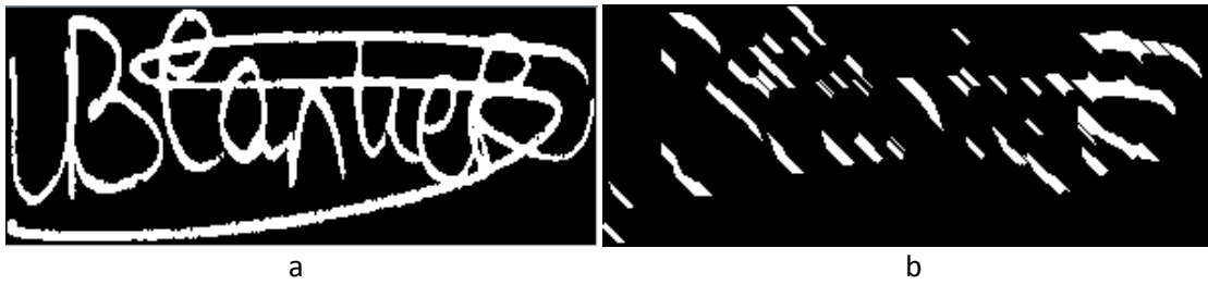
Şekil 20: (a) Özgün Görüntü ve (b) 7 Uzunluğunda Soldan Sağa Yapıcı Ögesi ile Açılım Uygulanmış Görüntü
