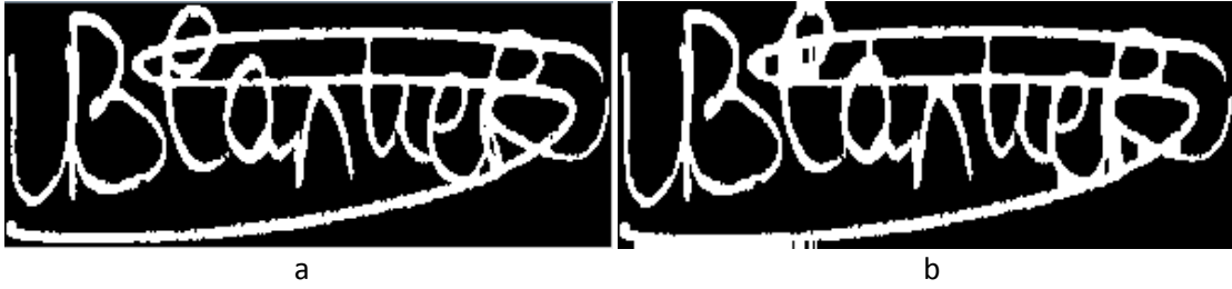
Şekil 29: (a) Özgün Görüntü ve (b) 7 Uzunluğunda Dikey Yapıcı Ögesi ile Kapanım Uygulanmış Görüntü
