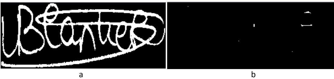
Şekil 12: (a) Özgün Görüntü ve (b) 7 Uzunluğunda Kare Yapıcı Ögesi ile Aşınım Uygulanmış Görüntü
