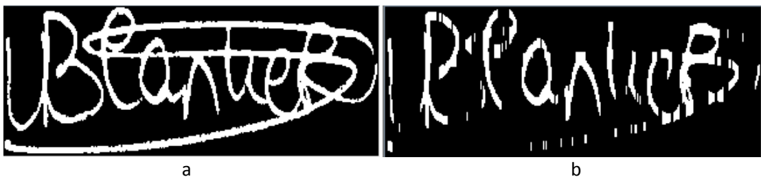
Şekil 28: (a) Özgün Görüntü ve (b) 7 Uzunluğunda Dikey Yapıcı Ögesi ile Açılım Uygulanmış Görüntü
