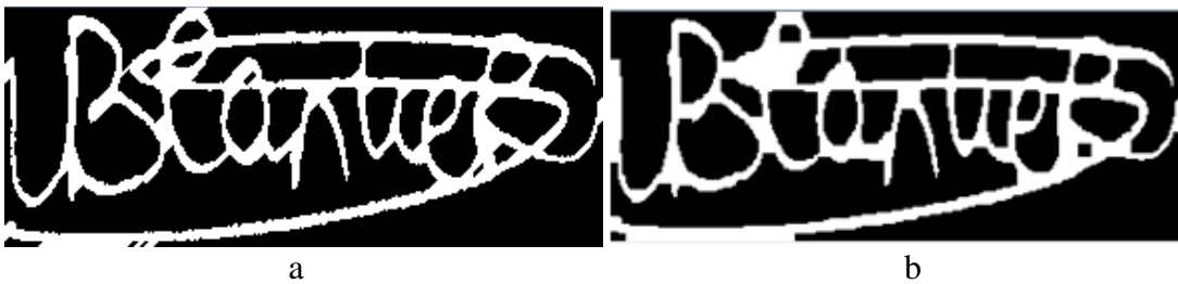
Şekil 28: (a) Özgün Görüntü ve (b) 7 Uzunluğunda Kare Yapıcı Ögesi ile Kapanım Uygulanmış Görüntü
