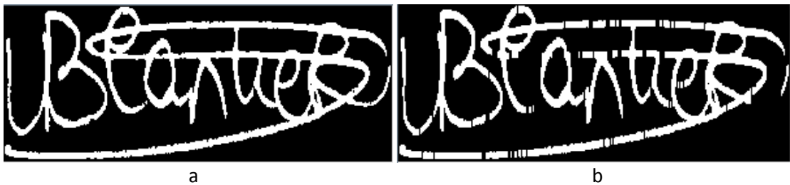
Şekil 16: (a) Özgün Görüntü ve (b) 5 Uzunluğunda Dikey Yapıcı Ögesi ile Açılım Uygulanmış Görüntü
