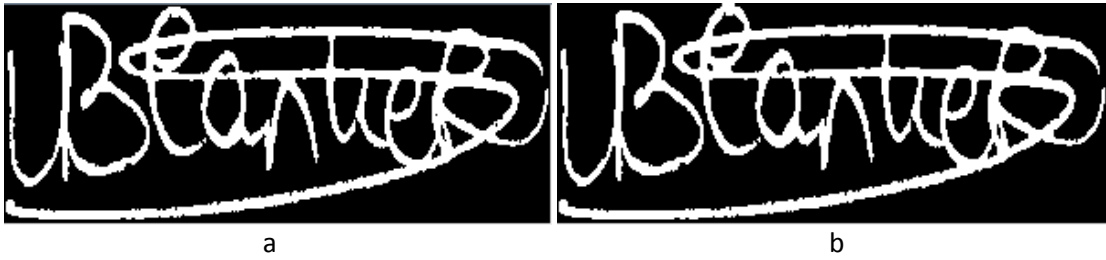
Şekil 23: (a) Özgün Görüntü ve (b) 3 Uzunluğunda Dikey Yapıcı Ögesi ile Kapanım Uygulanmış Görüntü
