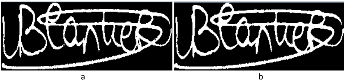
Şekil 36: (a) Özgün Görüntü ve (b) 3 Uzunluğunda Sağdan Sola Yapıcı Ögesi ile Kapanım Uygulanmış Görüntü
