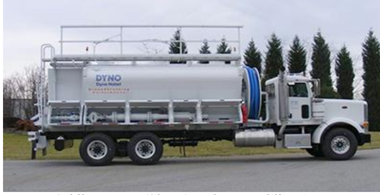
Şekil 2.7 Harç (Slurry) Patlayıcı Nakliye Aracı
