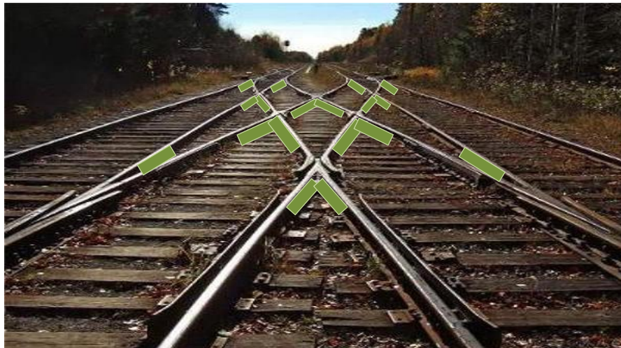
Şekil 4.18 Demiryolu elemanlarına patlayıcı yerleştirme şeması.
