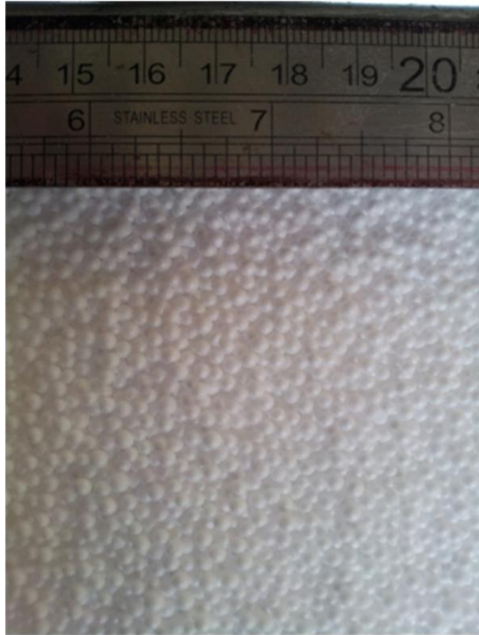
Şekil 1.3 EPS hammaddesinin ön şişirme işlemi sonucunda elde edilen çapları 1 mm – 4 mm arasında değişen EPS boncuklar
