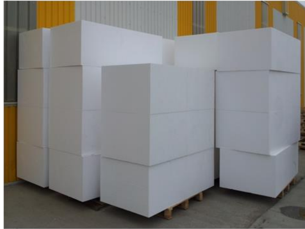
Şekil 2.5 Depo sahasında EPS Blokların dinlendirilmesi (Yer: TRC Yalıtım, Batman; Fotoğraf: A. Tolga ÖZER, Tarih: 22.05.2015)
