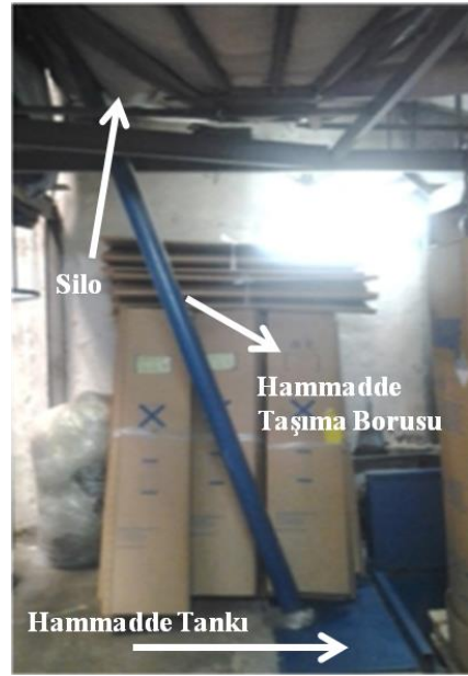
Şekil 2.1 Tedarik edilen EPS hammaddelerinin borular aracılığıyla hammadde tankından silolara taşınması (Yer: Birsanpor, Alibeyköy; Fotoğraf: Şeyma KOÇ, Tarih: 29.01.2014)
