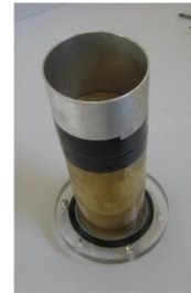
(c) Pirinç numune alıcı üzerine 6.4 cm yüksekliğinde sabit hidrolik yük uygulanmak üzere ilave ring montajı
