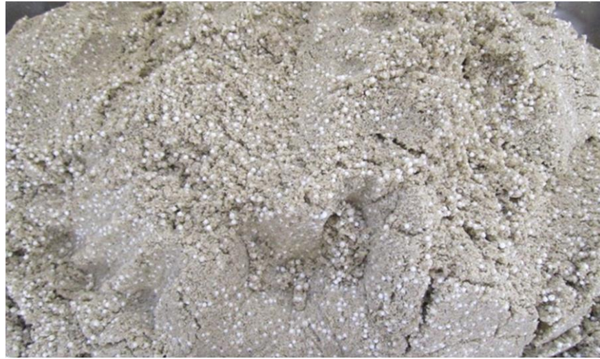
Şekil 4.9 EPS boncuk + kum karışımından oluşan hafif dolgu malzemesi (Ağırlıkça EPS boncuk miktarı = %0.5)
