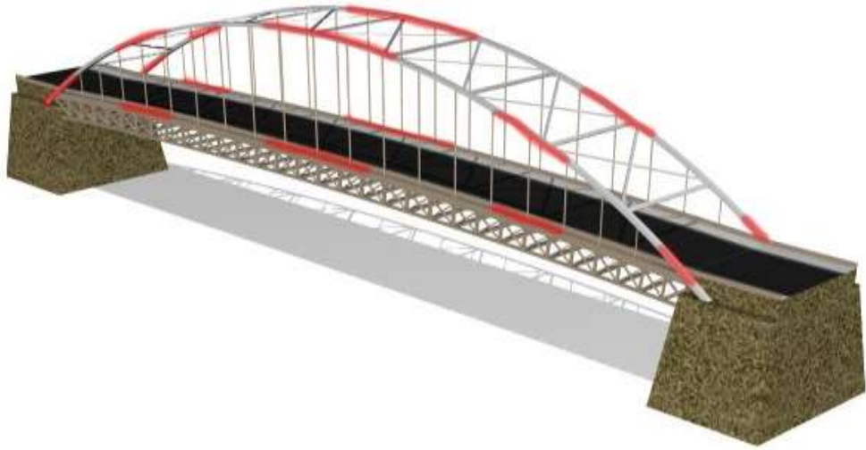
Şekil 2.19: Betonarme Köprüde Patlatma Bölgeleri (Özyurt, 2013)
