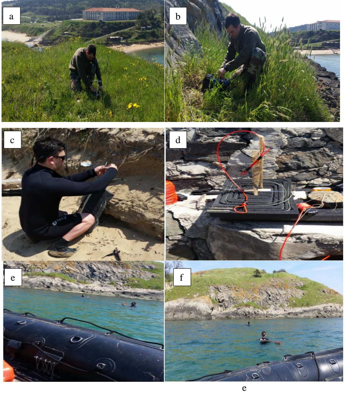
Şekil 3.3. Ölçüm Çalışmaları a,b) Titreşim ölçer cihazların kurulması c,d) Sulatı patlatma düzeneklerinin hazırlanması e,d) Patlayıcıların dibe sabitlenmesi ve çakmakların çekilmesi
