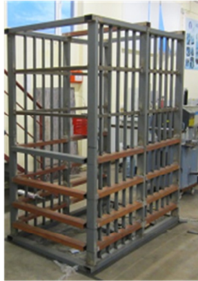
(m) Kutunun dış çelik iskeletinin yanıl profillerle güçlendirilerek iskeletin montajı tamamlanması
