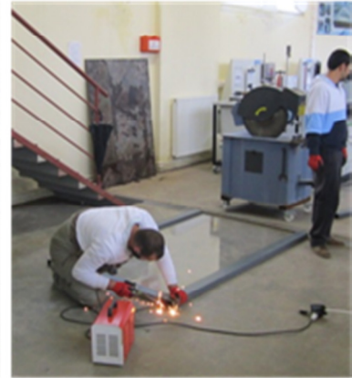
(f) Taban PMMA levhanın etrafına çelik taban profillerinin yerleştirilerek kaynakla birleştirilmesi
