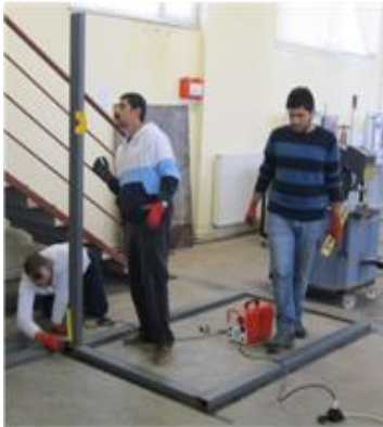
(g) Kutu dış iskeletini oluşturacak çelik dikmelerin taban profillerine kaynatılması
