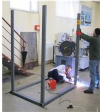
(h) Kutu dış iskeletini oluşturacak çelik dikmelerin taban profillerine kaynatılması işleminin ilerlemesi
