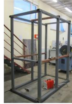
(k) Kutunun dış çelik iskeletinin yanıl profillerle güçlendirilmesi
