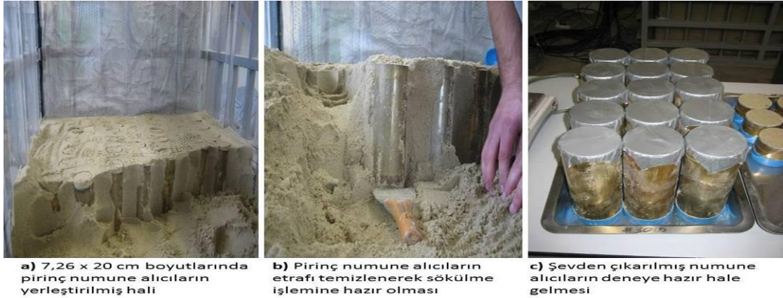
Şekil 3.7 CD deneyleri için örselenmemiş numune alma işlemleri
