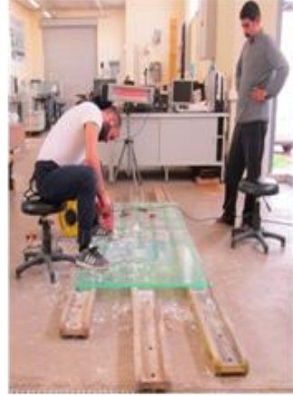
(c) PMMA ayırma plakasına 8 mm genişliğinde delik açılması işleminin ilerlemesi
