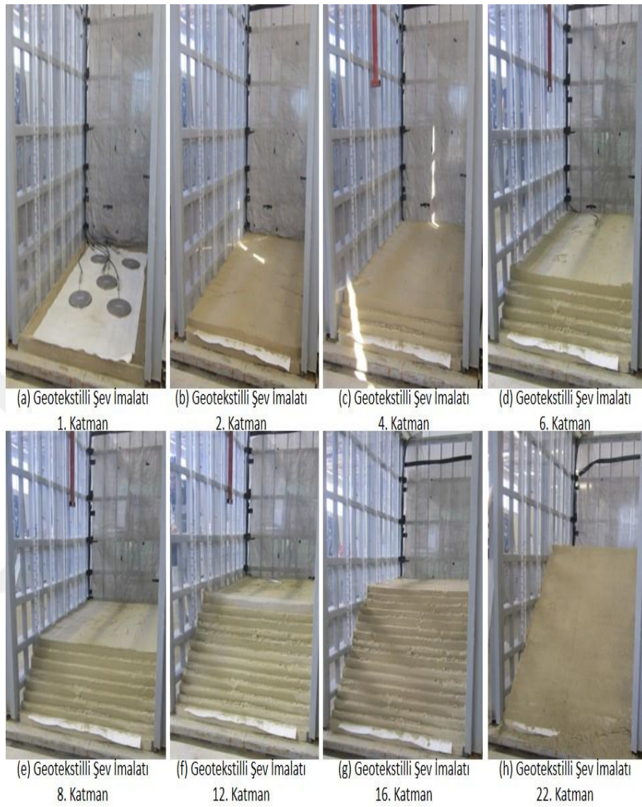
Şekil 3.5 Geotekstil üzerine inşa edilen dolgunun imalat aşamaları
