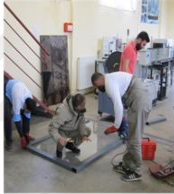
(e) Taban PMMA levhanın etrafına çelik taban profillerinin yerleştirilmesi
