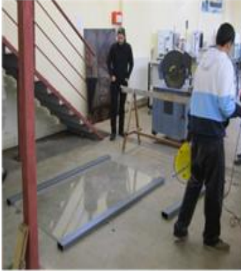
(d) 108 cm x 200 cm x 2 cm boyutlarında taban PMMA levhanın zemine yerleştirilmesi
