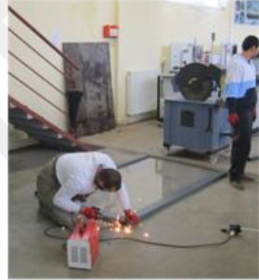
(f) Taban PMMA levhanın etrafına çelik taban profillerinin yerleştirilerek kaynakla birleştirilmesi
