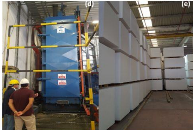
(d) ön şişirilme işleminden sonra kalıplama aşaması (Yer: Austrotherm, Dilovası/Kocaeli; Fotoğraf: A. T. Özer, Tarih: 17.08.2016)
