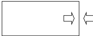
Şekil III.22 Dikdörtgen, kapılar tek kısa kenardan giriş çıkış
