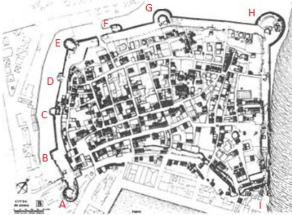
Plan 4: Kalenin burçlarını gösterir çizim. A -Güney burcu B -Üçgen burç C - Güneybatı burcu D -Üst kısmı yıkılmış olan burç E -Çokgen planlı batı burcu F -Üst kısmı büyük ölçüde yıkılmış olan batı kapısı burcu G - Kuzeybatı burcu H -Kuzey burcu (Antonio Zeno Burcu) I - (Bugün tümüyle yıkılmış olan) Doğu burcu (G. ORTOLANI).
