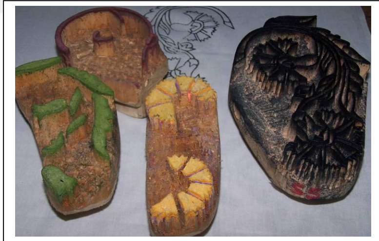
Resim 63: Sağdaki kontur kalıbıdır diğerleri dolgu kalıbı.
