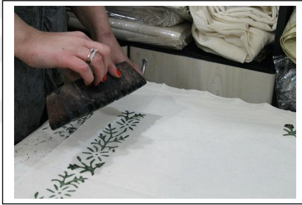
Resim 45: Bitkisel motifli kontur kalıbı.
