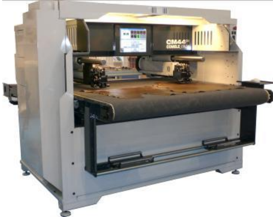
Resim 219: Bilgisayar kontrollü çift kafa kesim makinesi.
