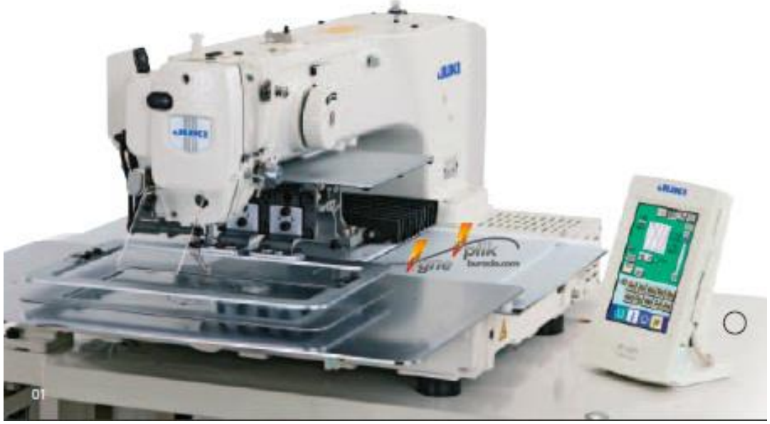
Resim 220: Otomatik saya dikme makinesi.
