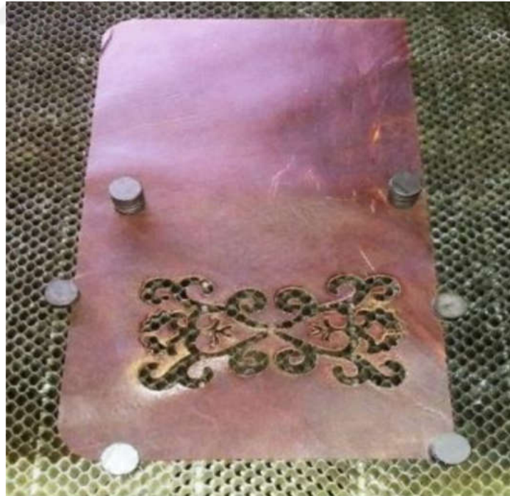
Şekil 287: Deri Üzerine Lazer Kesiminin Tamamlanmış Hali
