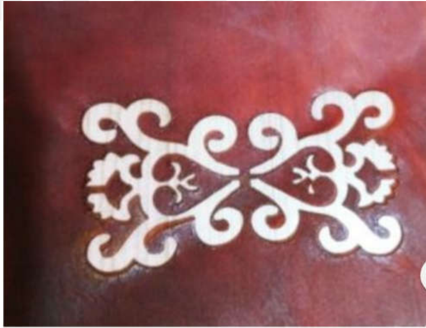
Şekil 289: Lazer Kesim Anında Çıkan Parçaların Alınarak Temizlenmesi Ve Deri Üzerine Lazer Kesim Uygulanmasının Tamamlanması
