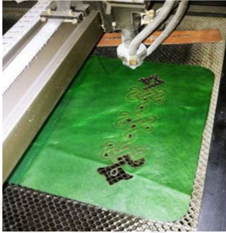
Şekil 286: Deri Üzerine Lazer Kesiminin Tamamlanmış Hali
