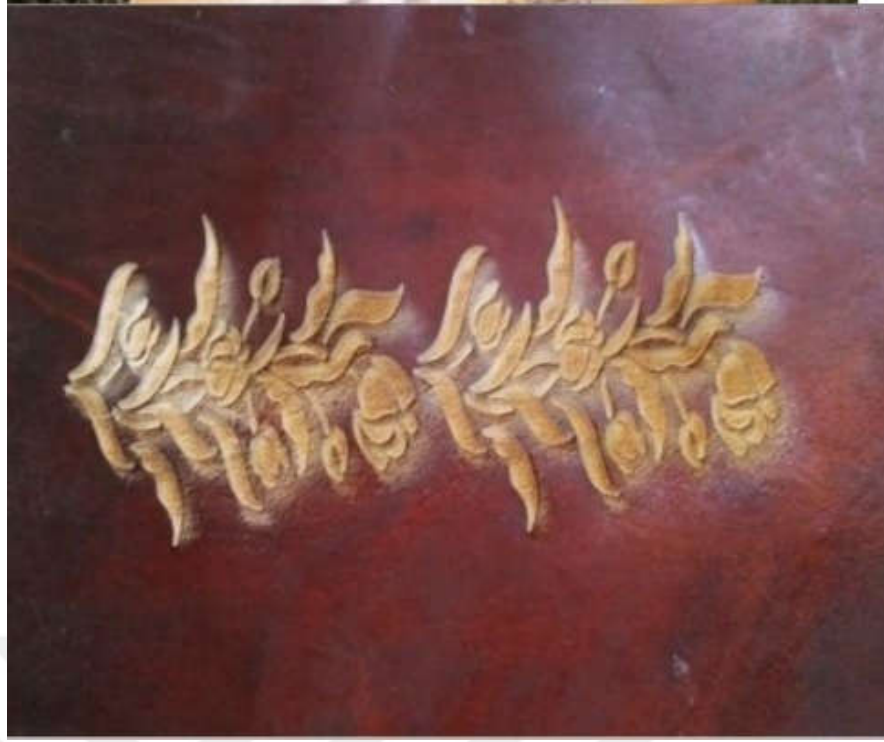
Şekil 290: Deriye Üzerine Gül ve Gül Goncası Motiflerinden Oluşan Tasarımın Lazerle Kazıma Çalışması
