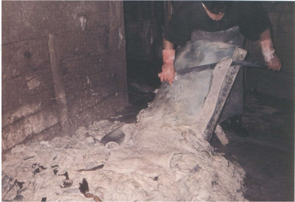
Şekil 199: Derinin Kıl Kökleri ve Üst Tabakasının Giderilmesi
