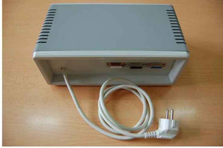
Şekil 4.18 \pm 200V bipolar güç kaynağının kutulanmış şekli.
