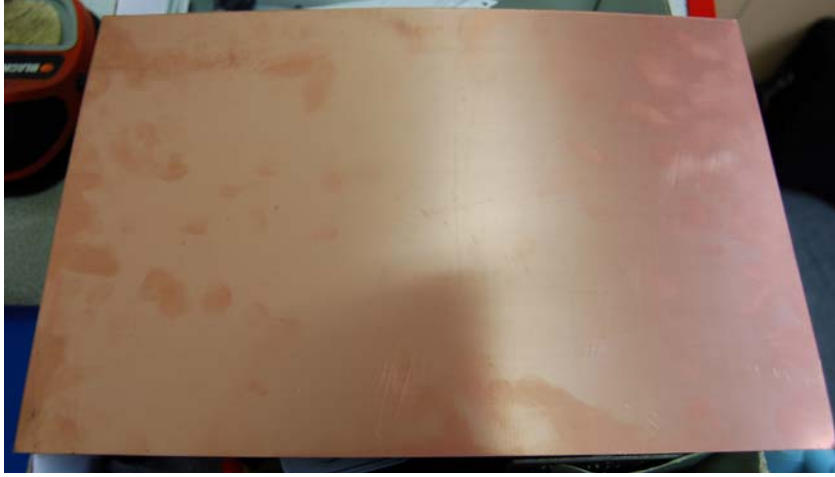
Şekil 3.4 Kullanılan teflon baskı devre plakası.
