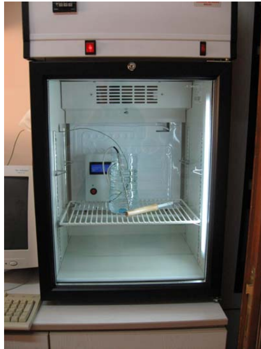
Şekil 3.15 Solarton ile BNS 1.0 cihazlarının karşılaştırılma testi
