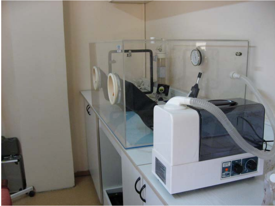
Şekil 3.18 Nem testi düzeneği ( Nem üretme cihazıyla beraber )
