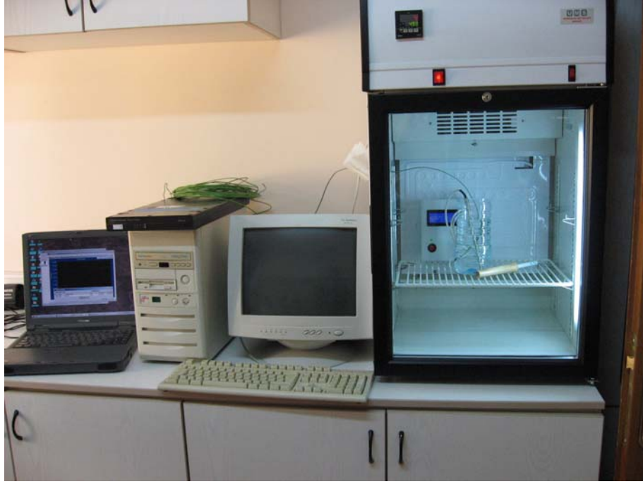
Şekil 3.14 Solarton ile BNS 1.0 cihazlarının karşılaştırılma test düzeneği
