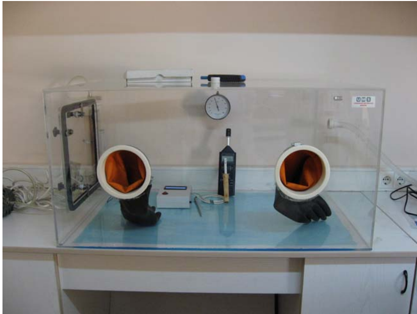
Şekil 3.16 Nem testi düzeneği ( Nem üretme cihazından önce )
