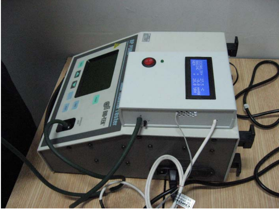
Şekil 3.13 Biotek BP Pumb NIBP Monitor Tester ile BNS 1.0 cihazlarının karşılaştırılma testi
