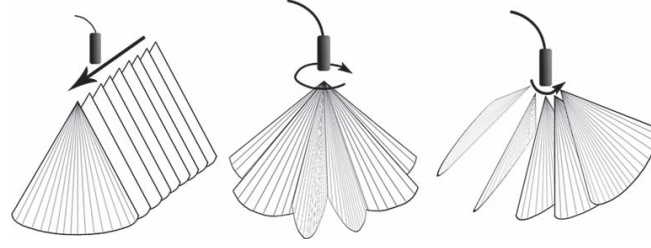
Şekil 1.11 3D Ekokardiyografi probunun çalışma biçimi (Shiota Three Dimensional Echocardiography)
