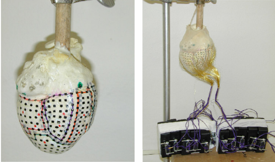
Şekil 2.11 490 elektrotla çevrili ventrikül geometrisi. Sol tarafta elektrotların kalp üzerindeki yerlerini gösteren orta büyüklükteki bir köpek kalbi kalıbı, sağ tarafta ise 490 elektrotlu çorap dizisinin kalıp üzerinde yerleştirilmesi ve elektrot kablolarını veri toplama sistemine aktarmaya yarayan soketlerin beraber gösterimi mevcuttur. ([19]'dan alınmıştır.)
