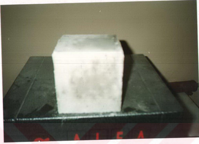
Şekil B.3. 15x15x15 cm 3 ebatlarındaki deney numunesinin görünüşü
