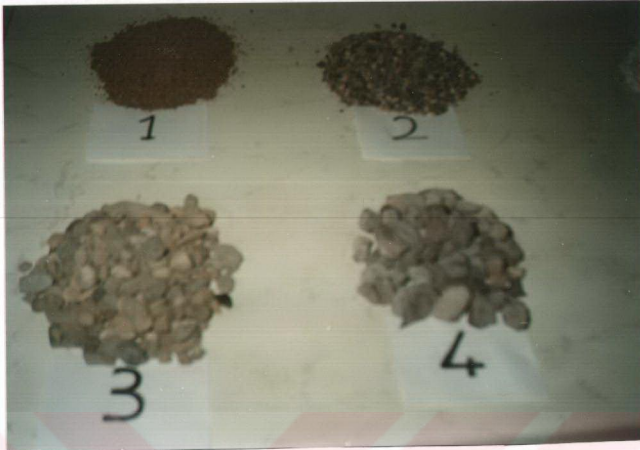
Şekil B.1. Deneilerde kullanılan malzemelerin görünüşü 1 ve 2 nolu malzemeler ince agrega (0-3, 3-7 mm.) 3 ve 4 nolu malzemeler iri agrega (7-15, 15-25 mm)
