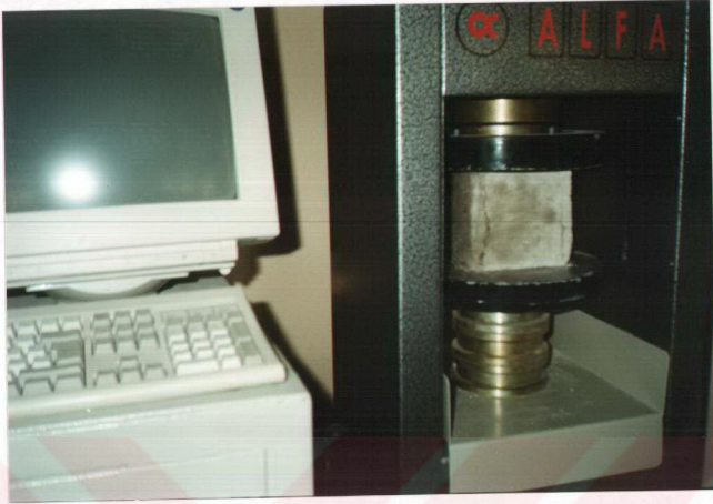
Şekil B.5. Deneş numunesinin basınç presinde kırılmış hali
