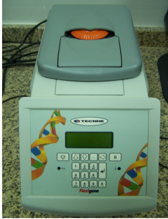
Şekil 3.3. PCR Cihazı (Thermal cycler, Techne Flexigene™, İngiltere)
