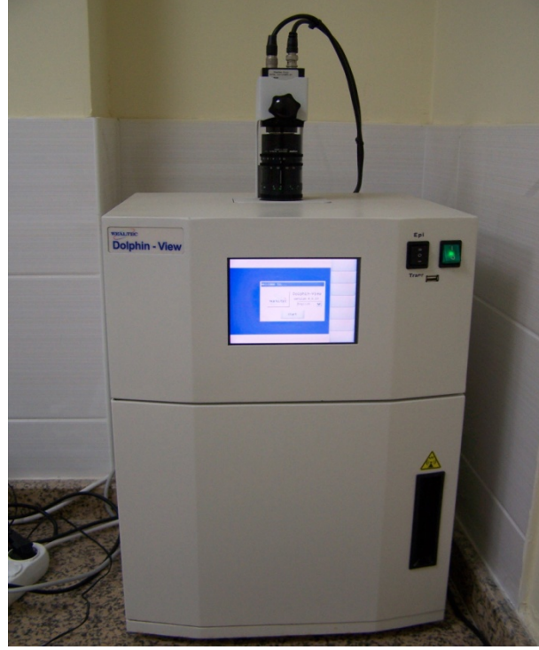
Şekil 3.5. Jel elektroforez sonrası PCR ürünleri görüntüleme cihazı (Wealtec Dolphin-View, ABD, UV Transilluminator).
