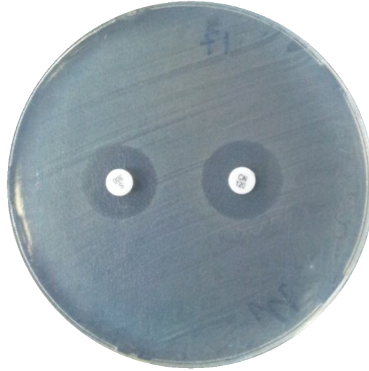
Şekil 3.3. Aminoglikozid direncinin disk difüzyon yöntemi ile değerlendirilmesi
