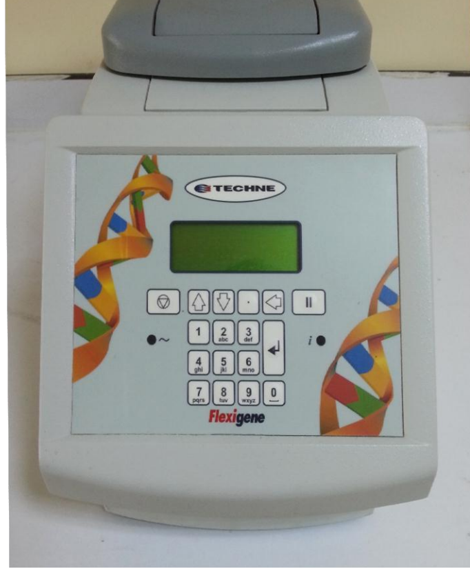
Şekil 3.1. PCR amplifikasyonunda kullanılan ısı döngü (Thermal cycler, Techne Flexigene, İngiltere) cihazı.
