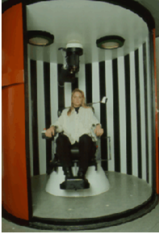
Şekil 2.7 Tüm görsel alanı uyaran optokinetik silindir [22]
