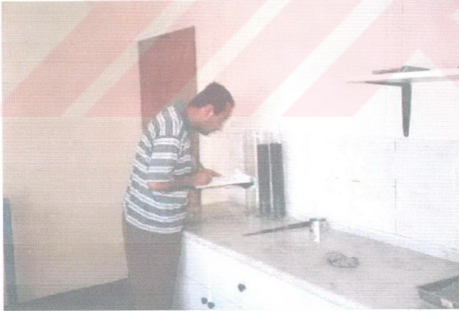
Foto 3.8 Hidrometre deneyi okumasından bir görünüm.
