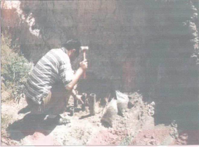
Foto 3.2 Zeminden örselenmiş ve örselenmemiş numune alımı
