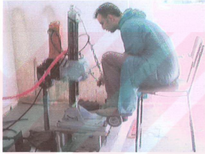
Foto 4.1 Karotiyer makinesi ve BX çaplı karot alınışı
