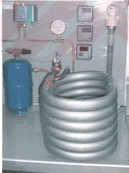
Şekil 3.13 Deney tesisatında yoğuşturucunun görünümü
