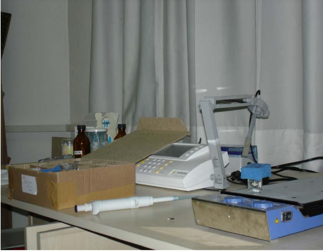
Şekil 3.2 Kristalin manyetik karıştırıcıda çözelti ile etkileştirilmesi
