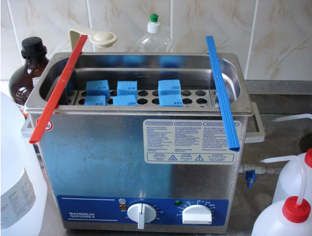
Şekil 3.4 Kristallerin ultrasonik banyoda deiyonize su ile yıkanması
