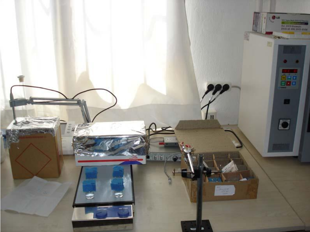
Şekil 3.7 Sistamin ve glutaraldehit immobilizasyonu için kristallere karanlık ortam sağlanması
