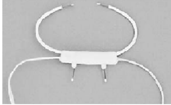
Şekil 3.3 - Üst Solunum Yolu Hava Akışının Gözlemlenmesini Sağlayan Termistör [6]
