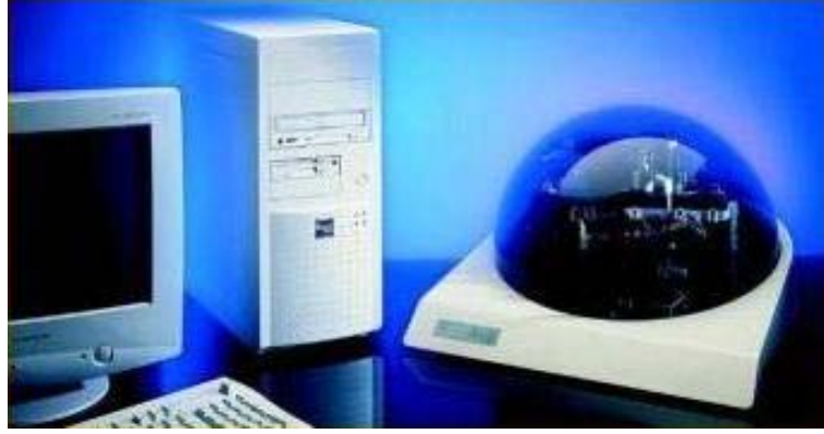
Şekil 6.2 Radon dedektörleri üzerindeki alfa izlerinin analizinde kullanılan görüntü işleme seti
