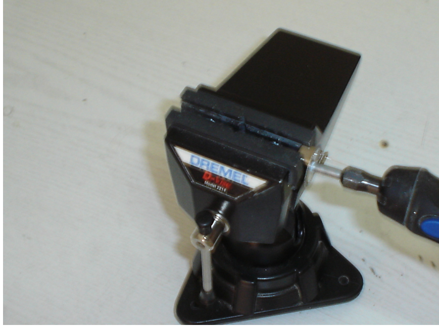
Şekil 3.1 Metal Kılıfların Kesilmesi
