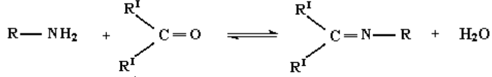
Şekil 2.2 Schiff bazlarının hidroliz reaksiyonu
