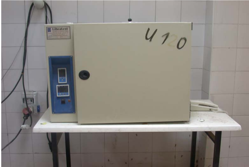
Fotoğraf 3.1. Plaj kumu örneklerinin etüvde kurutulması
