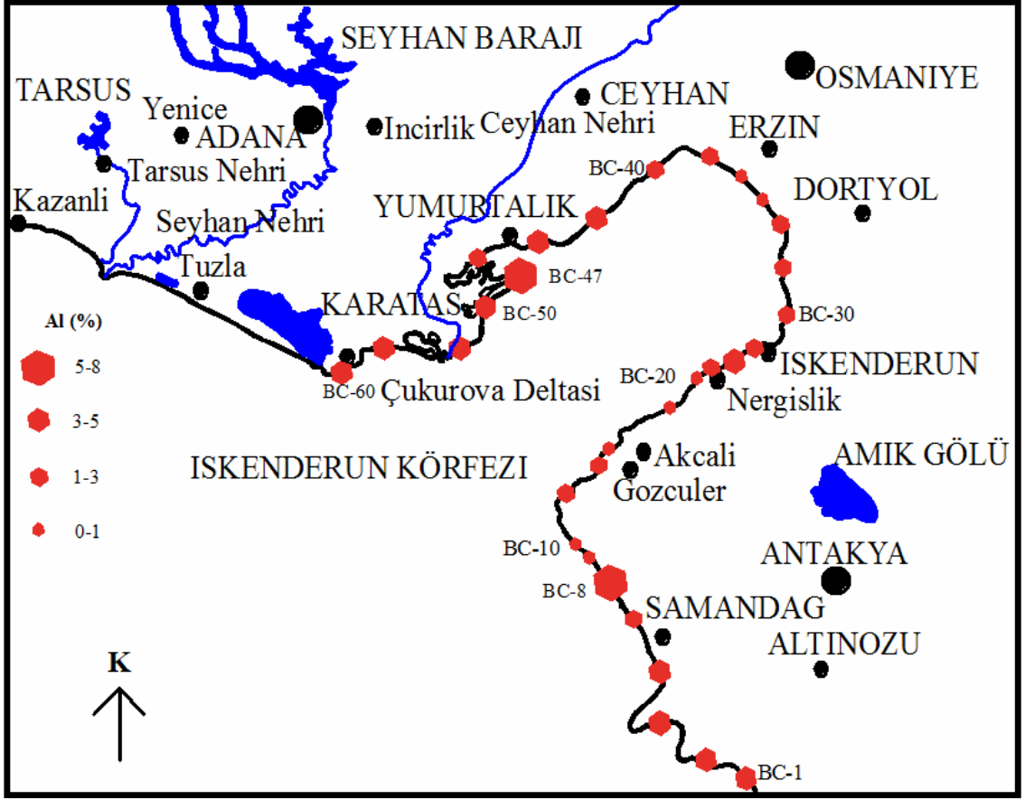
Şekil 4.12. İskenderun Körfezi'ndeki plaj kum örneklerinin Al ağır metal içeriğinin dağılım haritası ((BC-8 (Yanikkule plajı), BC-47) Al içeriği yüksek anomali göstermiştir.)
