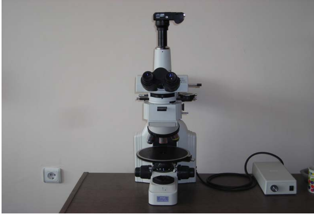
Fotoğraf 3.4. Nikon Pol-400 mikroskop ile incekesit ve parlak kesit incelenmesi
