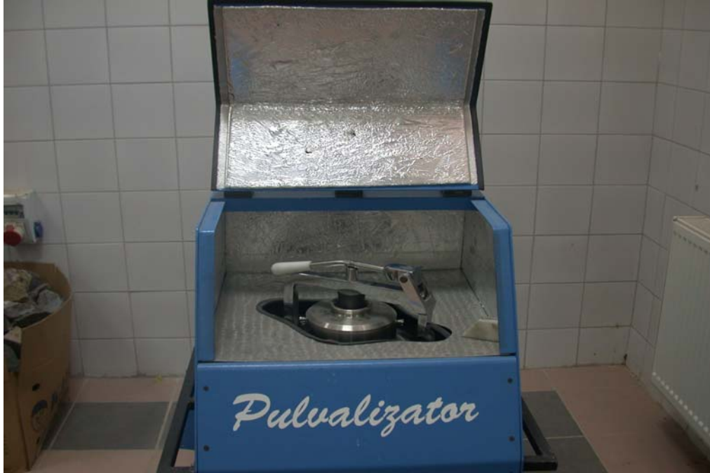
Fotoğraf 3.3. Plaj kumu örneklerinden çakıl olanların pulvalizatörde parçalanıp homojenize edilmesi
