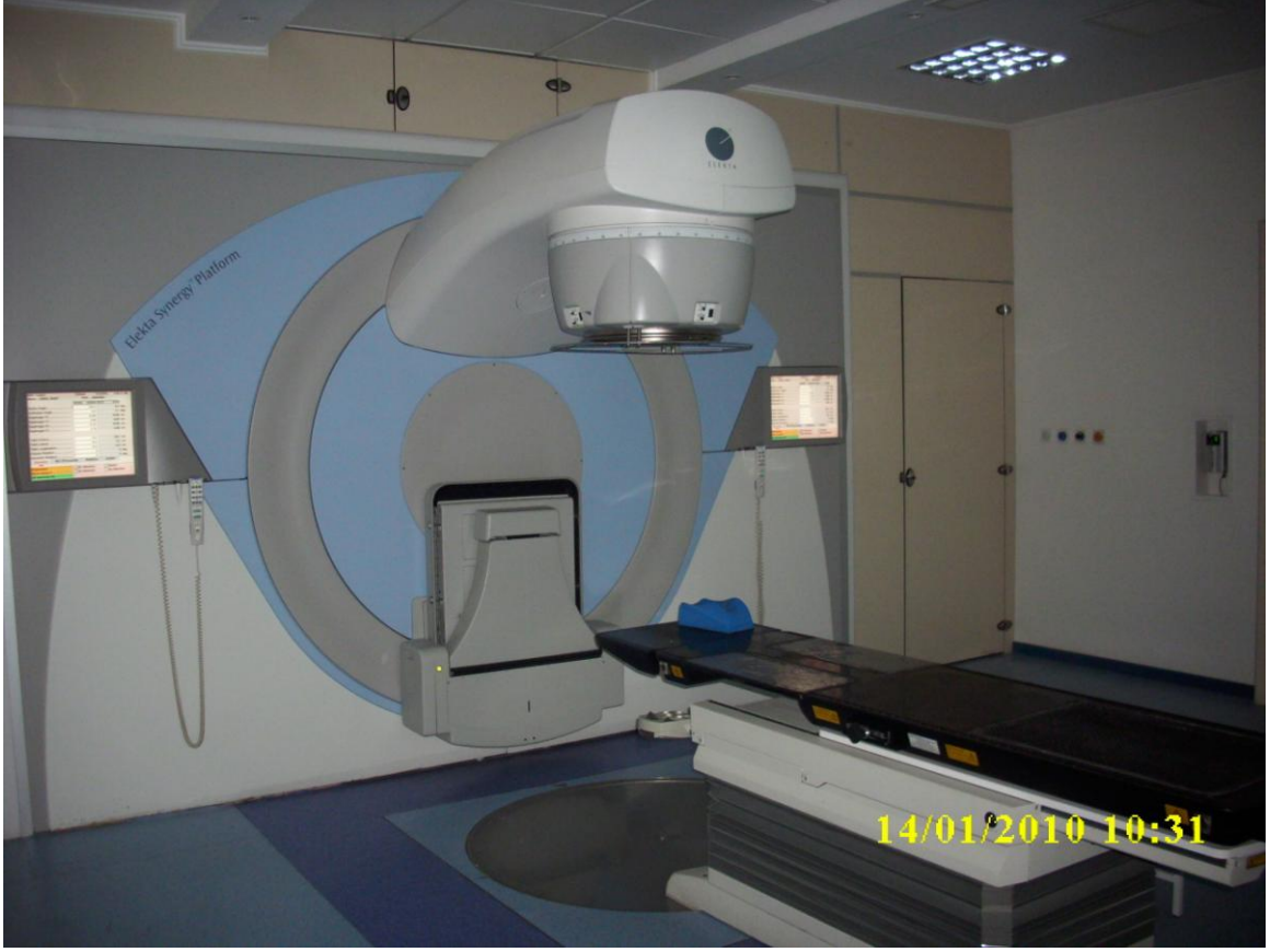
Şekil 3.1 Çalışmanın yapıldığı doğrusal hızlandırıcı cihazı (Elekta Synergy Platform).
