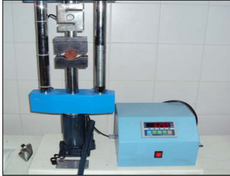
Fotoğraf 6.4 (a) Brazilian çekme dayanımı deneyinin yapılışı
