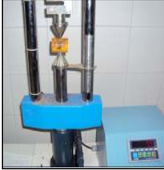
Fotoğraf 6.5 (a) Nokta yük dayanımının yapıldığı alet
