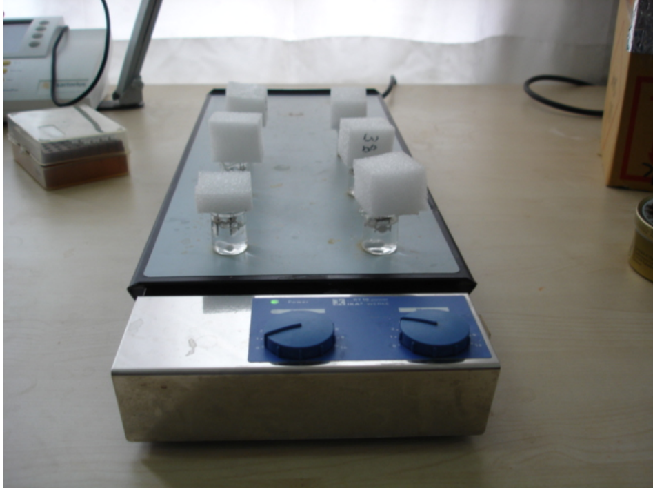
Şekil 3.6 Kuvars kristallerin manyetik karıştırıcıda çözelti ile etkileştirilmesi
