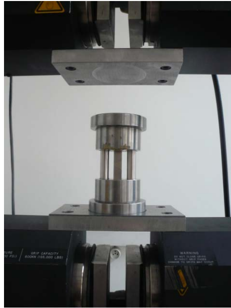
Şekil 5.5.3 Basma testi için hazırlanmış düz plakalar
