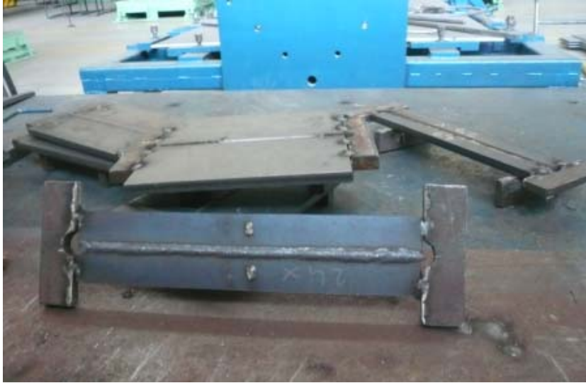
Şekil 5.3.1 MIG kaynağı ile birleştirilmiş parçalar
