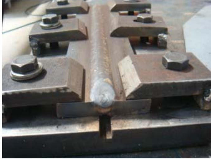
Şekil 5.3.2 Kaynakta çarpılmayı önleyen aparat
