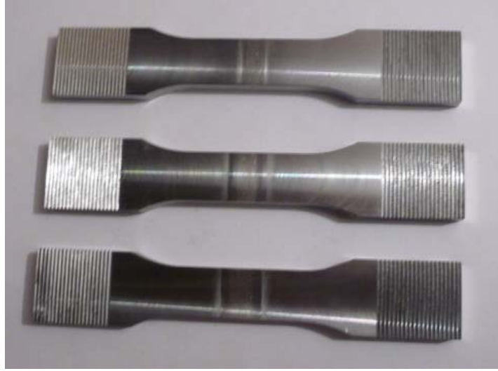
Şekil 5.3.3 Çekme numune yüzeylerine açılan dişlerin görünüşü
