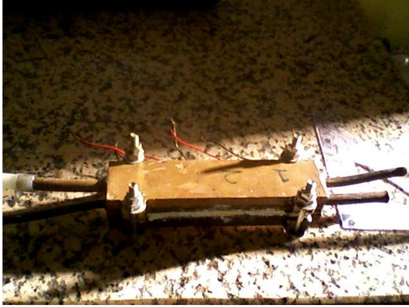
Şekil 7.3 Arasında TE modüller bulunan ısı değıştiricili elektrik üretim sistemi
