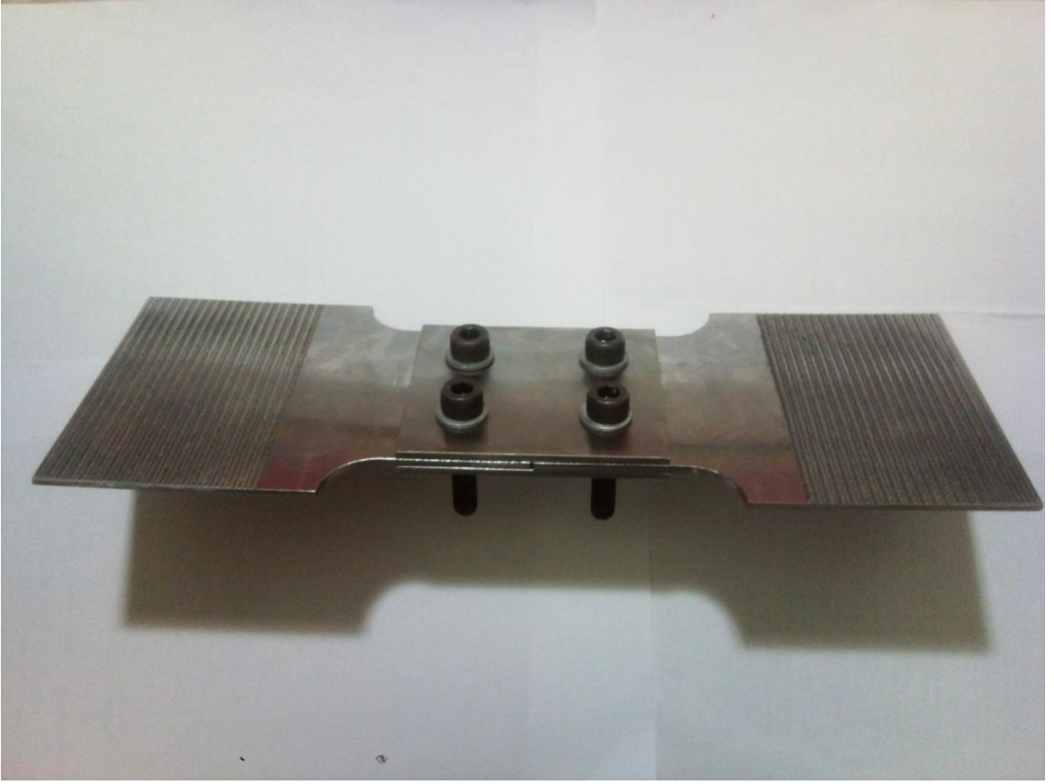
Şekil 5.5.1 Montajı yapılmış ve henüz deforme olmamış test numunesi
