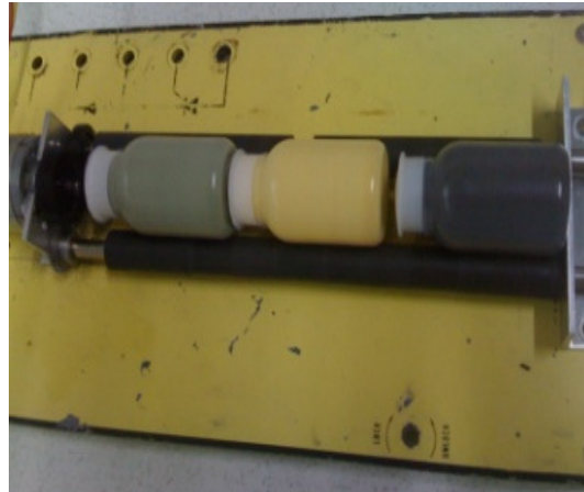
Fotoğraf 5.8 Kaplama karışımının homojenleştirilmesinde kullanılan bilyeli değirmen
