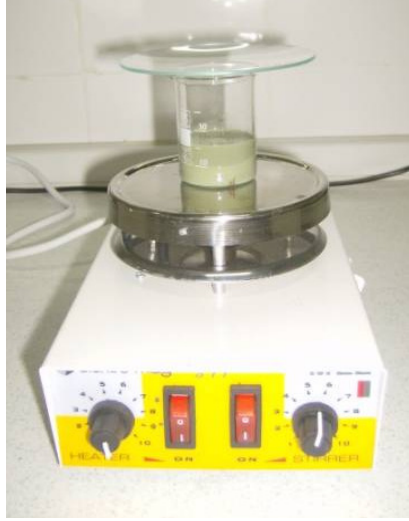
Fotoğraf 5.7 Manyetik karıştırıcı üzerinde hazırlanan kaplama karışımı (çamuru)
