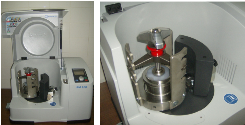
Fotoğraf 5.6 Otomatik agat öğütücü sistemi (ball mill) (Retsch marka)
