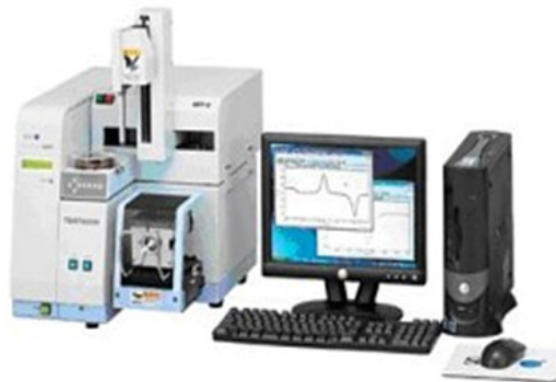
Fotoğraf 5.13 Bilgisayar kontrollü DTA/TG ölçüm sistemi (Diamond TG/DTA-Perkin Elmer marka)
