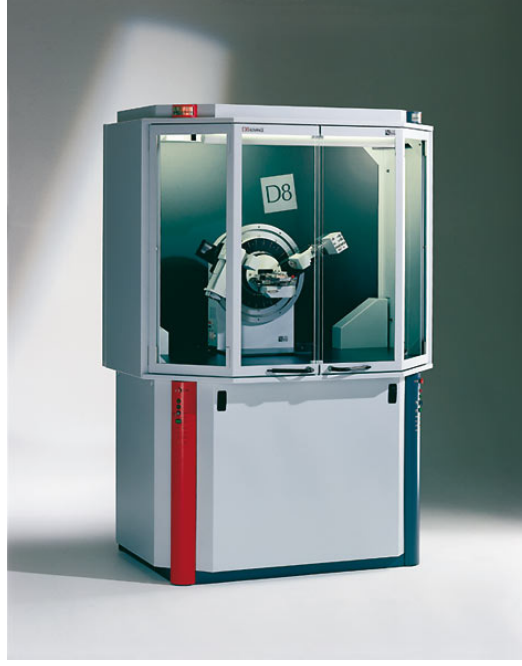
Fotoğraf 5.10 X-ışınları toz difraksiyon ölçümleri (XRD) için kullanılan sistem (Bruker AXS D8 Advanced tipi difraktometre)
