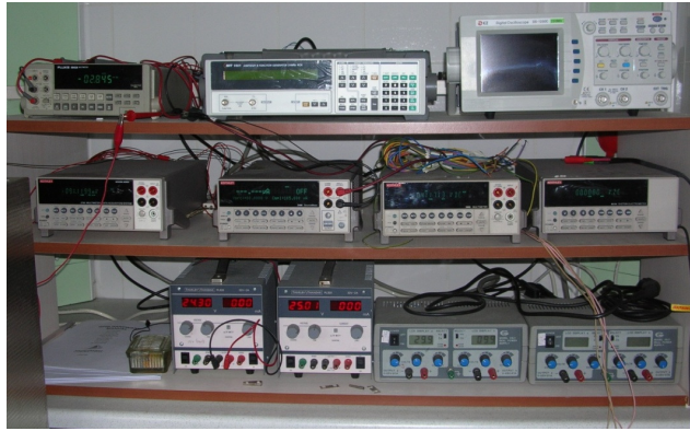
Fotoğraf 5.12 Bilgisayar kontrollü dört nokta d.c. elektriksel iletkenlik ölçüm sistemi
