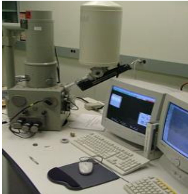
Fotoğraf 5.11 Ölçümlerde kullanılan taramalı elektron mikroskobu (SEM) sistemi (LEO 440 Computer Controlled Digital marka)
