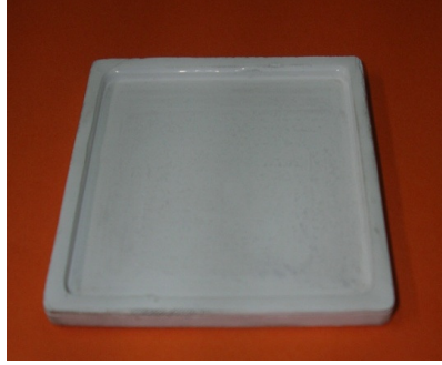
Fotoğraf 5.5 Özel olarak tasarlanan ve yaptırılan (6 cm x 6 cm) yüksek sıcaklığa dayanıklı alumina esaslı ince tabaka sinterleme tablası
