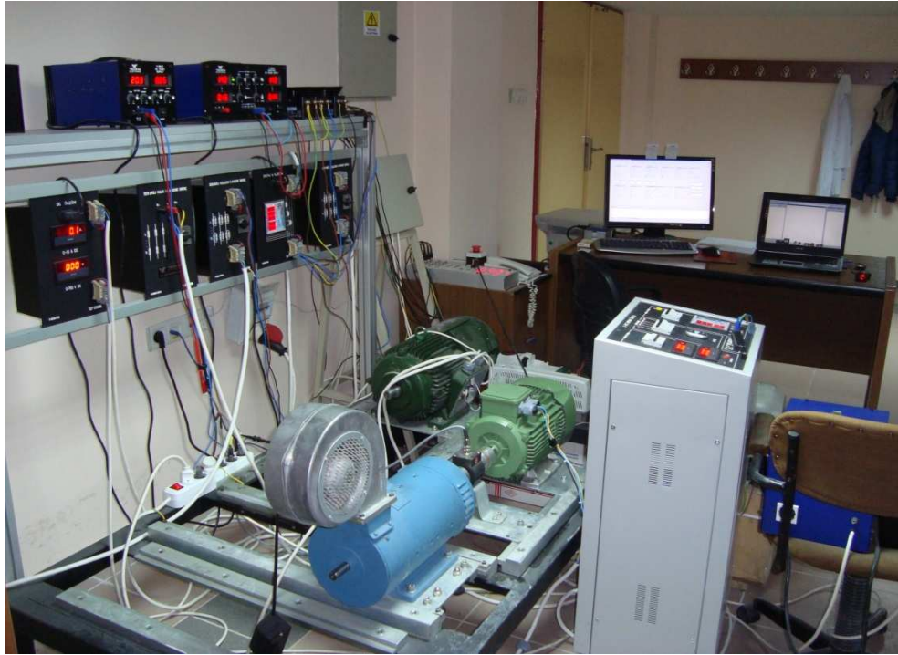
Fotoğraf 4.1 Gerçek-zamanlı çalışmada ASM verilerinin elde edildiği deney düzeneği
