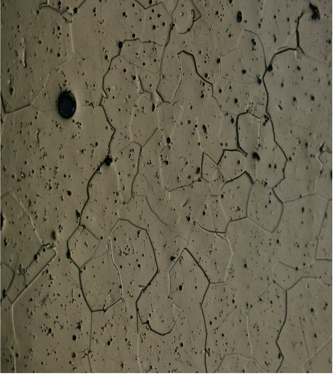
Fotoğraf 5.3. Fe-%40Mn-%2Si alařımında oda sıcaklıęında %2 Nitrik asit, %98 etanol daęlayıcı kullanılarak bulunan austenit yapı
