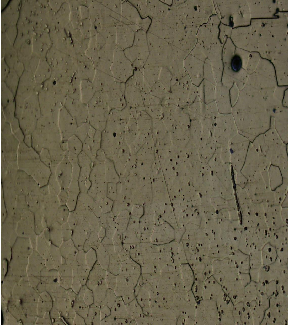
Fotoğraf 5.4. Fe-%40Mn-%5Si alařımında oda sıcaklıęında %2 Nitrik asit, %98 etanol daęlayıcı kullanılarak bulunan austenit yapı
