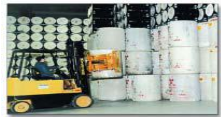
Fotoğraf 5.1. Radyoaktif atıkların çelik varillerde depolanması (Taek, 2010)
