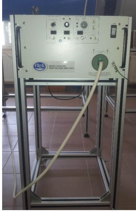
Fotoğraf 3.2. TREK MODEL 20/20C-HS yüksek voltaj amfisi
