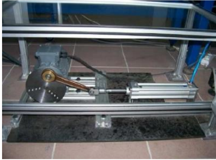
Şekil 1.8. Sentetik jet eyleyici (Akansu ve Fırat, 2010)
