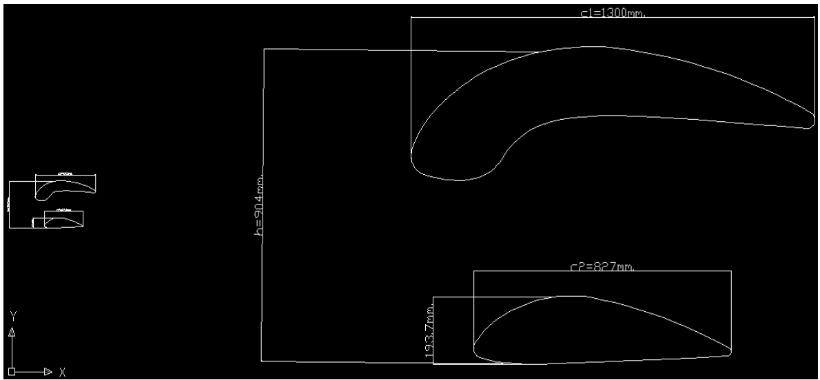
Şekil 3.12 İkili kanat profilinin prototip ve model ölçüleri
